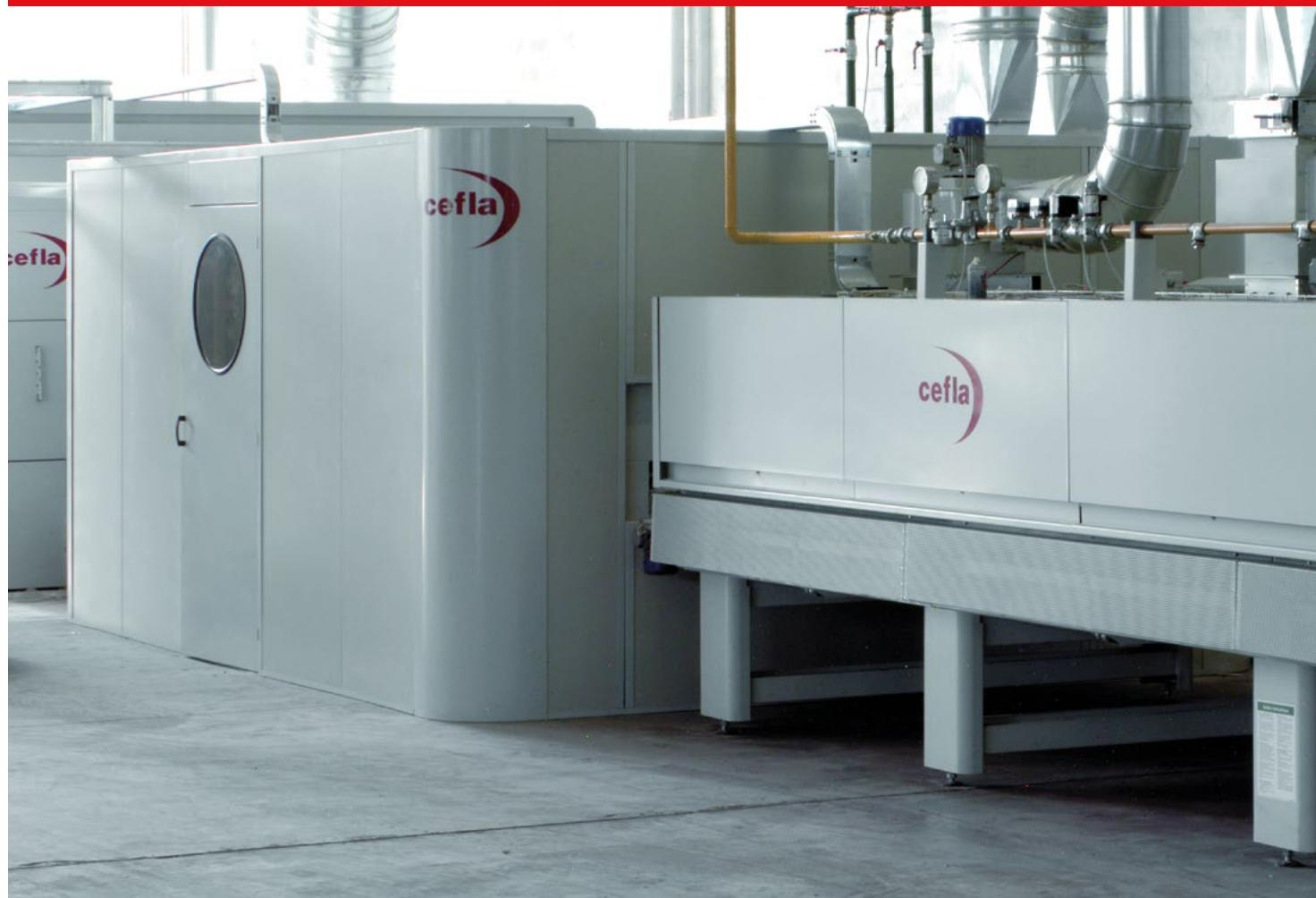
**GLASSOVEN** I forni ad alta temperatura CAT possono asciugare smalti ceramici (o altre tipologie di vernice) in preparazione alla successiva cottura nella fornace di tempra. L'irradiazione infrarosso è ottenuta grazie a speciali bruciatori catalitici, senza fiamma, attivabili con il gas naturale (metano) oppure con il GPL. Ciascuna piastra catalitica è in grado di erogare contemporaneamente raggi ed aria calda, con notevole risparmio energetico.
